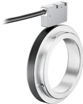
Der lagerlose Drehgeber RLI500, bestehend aus Magnetring und Sensorkopf, ist mit seiner Einbautiefe von min. 10 mm bestens geeignet für beengte Installationsmöglichkeiten. Das berührungslose Messprinzip ermöglicht einen fehlerfreien Einsatz auch unter widrigen Umgebungsbedingungen und eine lange Lebensdauer. Als Unterschied zu unserem Messsystem RLI200 ist hier auch ein einzelnes Referenzsignal realisiert.
