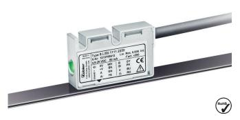
Das berührungslose inkrementale magnetische Längenmesssystem Limes LI50 / B2 - bestehend aus dem Sensorkopf LI50 und dem Magnetband B2 – ermöglicht eine Auflösung bis zu 5 µm bei einem maximalen Abstand von 2 mm zwischen Sensor und Band.
