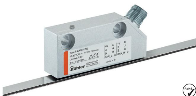
Le système de mesure linéaire magnétique absolu sans contact Limes LA10 / BA1 - composé du capteur LA10 et de la bande magnétique BA1 - atteint une résolution de 1 µm avec une distance maximale de 0,2 mm entre le capteur et la bande (bande de protection incluse).
