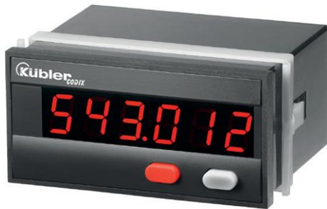
**Codix 543** 是一款电源供电的时间计数器、小时计或短時計，具有 4 种启动输入类型和单独可调的时基。6 位数的 LED 显示屏显示 NPN, PNP 输入信号的脉宽或周期持续时间测量。
