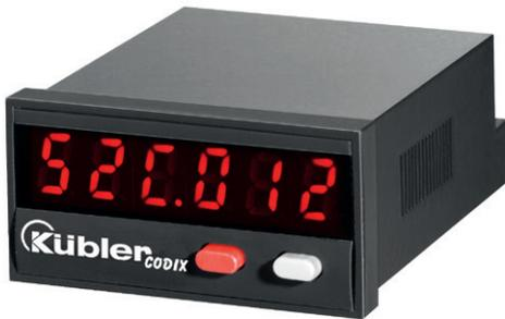
Der Codix 52C ist ein spannungsversorgter Doppel-Impulszähler mit getrennten Eingängen und getrennter Skalierung, für schnelle und langsame Zählimpulse, mit 6-stelliger LED Anzeige für NPN, PNP Eingangssignale und Anzeigeumschaltung A, B, A-B, A+B, A/B, (A-B)/A [%].
