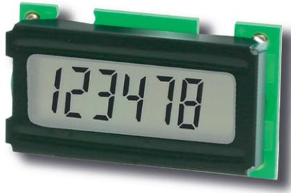
Der Typ 192 ist ein einkanaliges Zählmodul für Leiterplattenmontage mit großem Spannungsbereich von 8 bis 28 V DC und 6-stelliger LCD-Anzeige.
