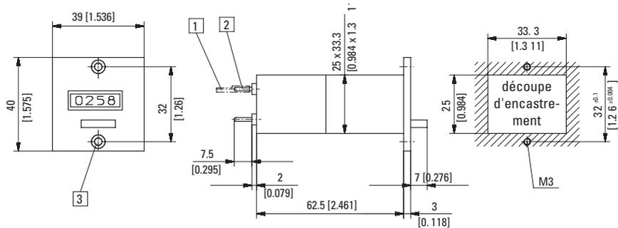
1) Connecteur à enfichage  $\varnothing$  1,5 [0.059], étamé 2) Broche ronde  $\varnothing$  1,6 [0.063], étamée 3) Fraisure Af3 DIN 74
