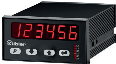
带 2 个独立扩展编码器输入功能的计数器，输入信号 **A, /A, B, /B**，其中每通道计数频率高达 **1 MHz**。可调节灵活的操作模式，主要用于位置或事件计数器、总累加器、差分计数器、切割长度显示、直径计算显示等应用。
