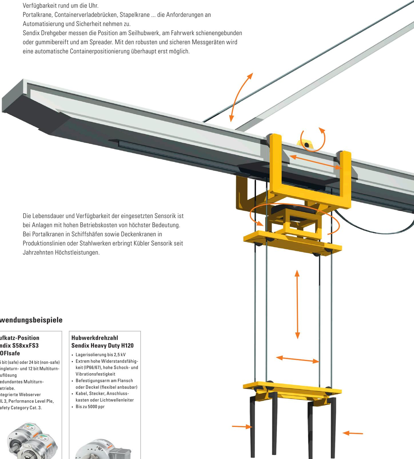
Die Lebensdauer und Verfügbarkeit der eingesetzten Sensorik ist bei Anlagen mit hohen Betriebskosten von höchster Bedeutung. Bei Portalkranen in Schiffshäfen sowie Deckenkranen in Produktionslinien oder Stahlwerken erbringt Kübler Sensorik seit Jahrzehnten Höchstleistungen.
